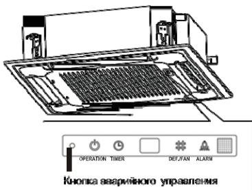
Аварийное управление применяется, если пульт ДУ утерян или вышел из строя, или разрядились элементы питания. С помощью кнопки АВАРИЙНОГО УПРАВЛЕНИЯ (MANUAL BUTTON), расположенной на панели управления внутреннего блока, можно выбрать режим ОХЛАЖДЕНИЯ (COOL) или АВТОМАТИЧЕСКИЙ режим работы кондиционера (AUTO). Нажимая эту кнопку, выберите режим работы кондиционера в следующей последовательности: АВТОМАТИЧЕСКИЙ, ОХЛАЖДЕНИЕ, кондиционер ОТКЛЮЧЕН, снова АВТОМАТИЧЕСКИЙ и т.д.
