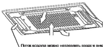
При включении этой функции направляющая заслонка будет автоматически покачиваться вверх-вниз. При отключении функции заслонка остановится в фиксированном положении. Угол покачивания заслонки на каждой стороне кассеты составляет 30°. При отключенном кондиционере (в том числе, если задано время включения кондиционера по таймеру) кнопка SWING не работает.
